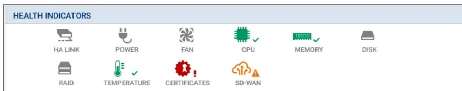
La couleur de l'icône SD-WAN varie selon l'état des routeurs et passerelles utilisés dans la configuration du firewall :
