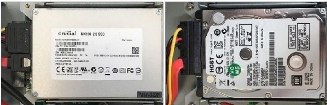
6. Ôtez les 4 vis de fixation du support du disque dur à l'aide du tournevis cruciforme.
