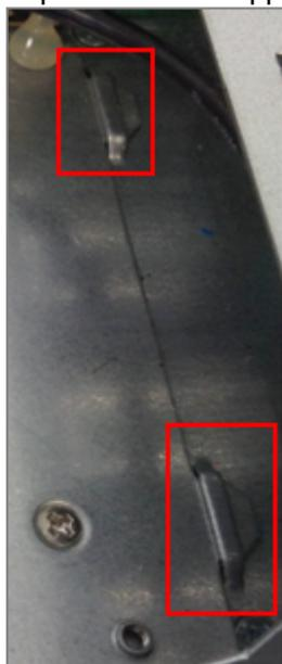
2. Poussez la tôle vers l'avant du châssis.
