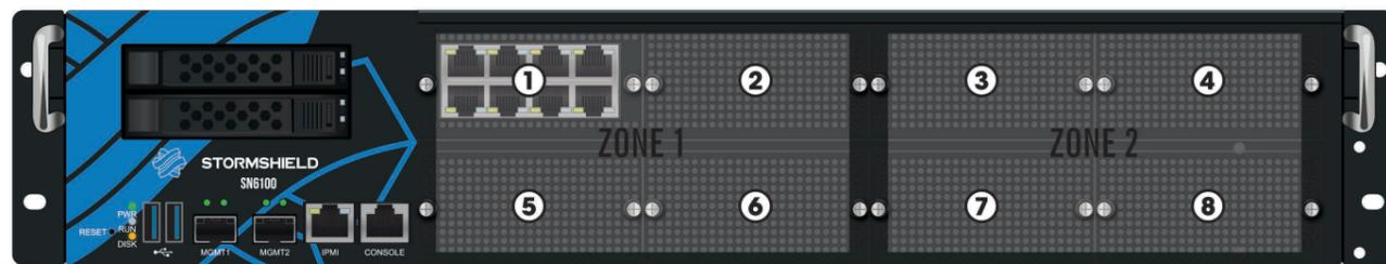
Les contraintes concernant le placement des modules sont les suivantes : les modules doivent être insérés de gauche à droite, en commençant par la rangée du haut.
