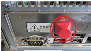
Branchez le câble réseau à l'arrière du châssis, sur l'interface réseau dédiée.
