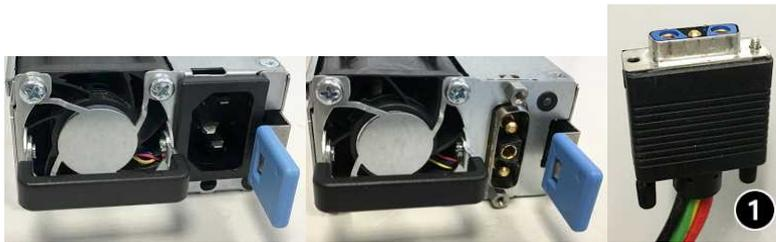
1. Débrancher la connexion d'alimentation du module à extraire,
